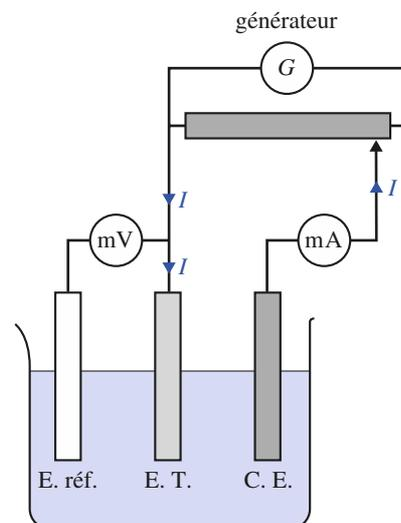
Doc. 4. Montage à trois électrodes pour relever les courbes intensité-potentiel.
